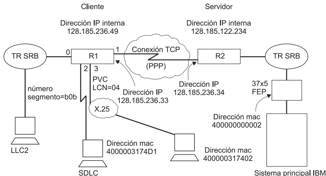
Figura 48. Diagrama de ejemplo para la configuración DLSw
