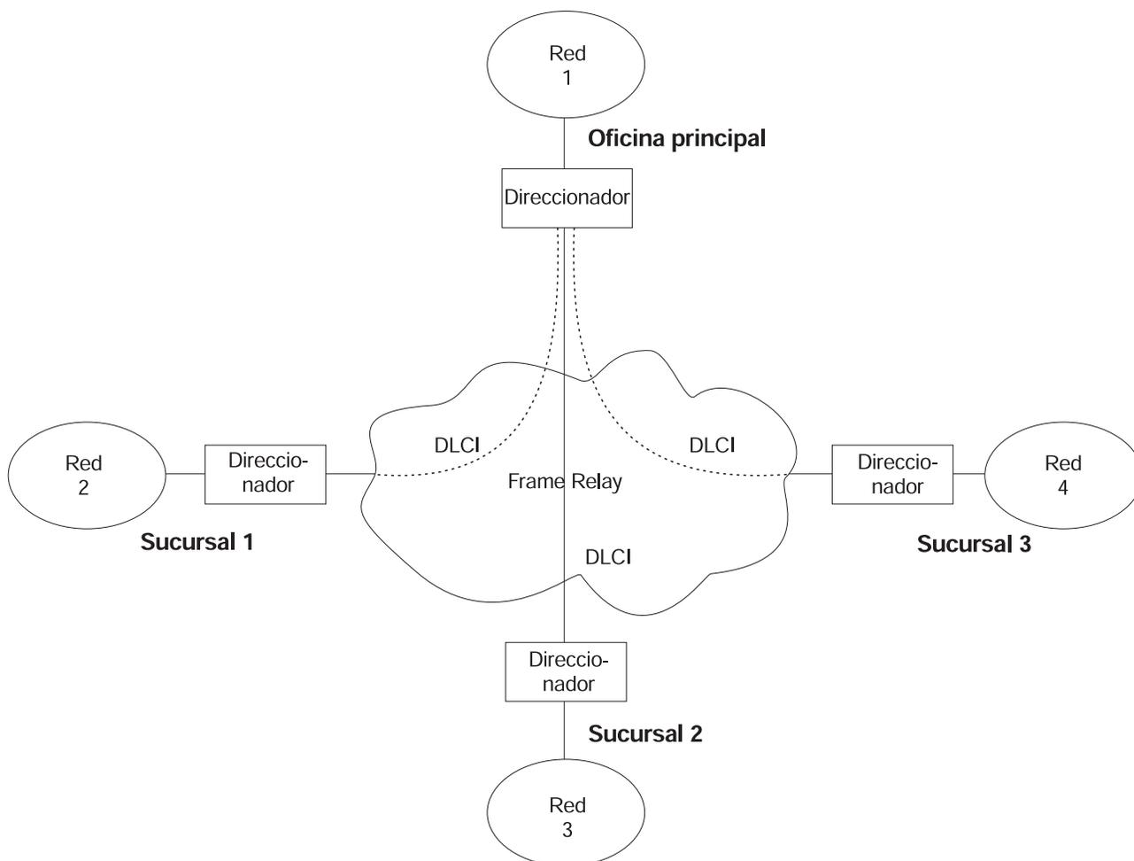
Figura 55. Red Frame-Relay de malla parcial
