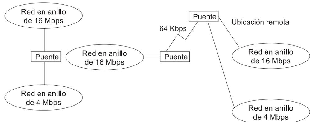
Figura 9. Ejemplo de conectividad por puente de direccionamiento de origen
