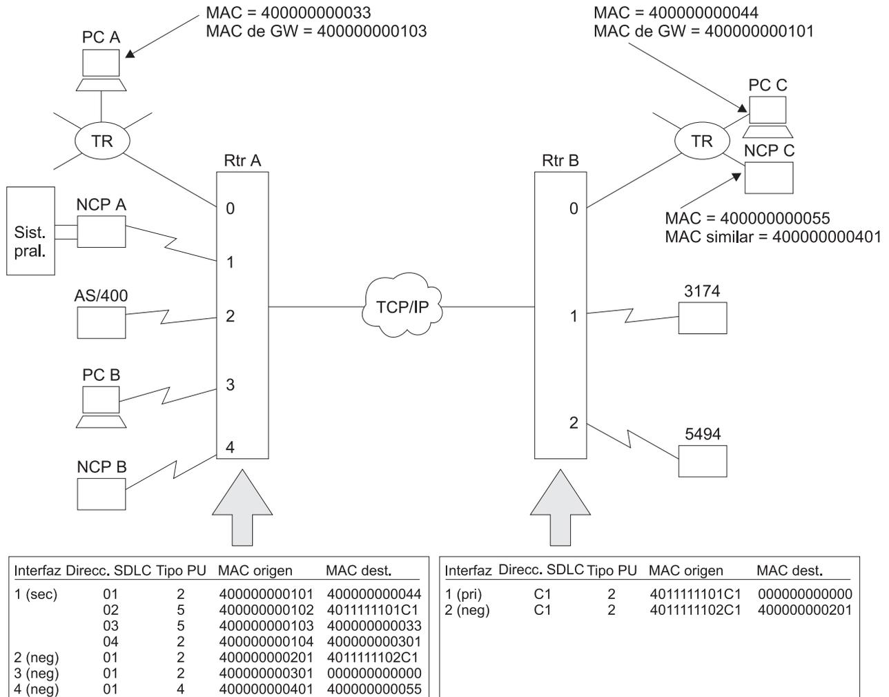
Figura 45. Configuraciones SDLC de DLSw de ejemplo
