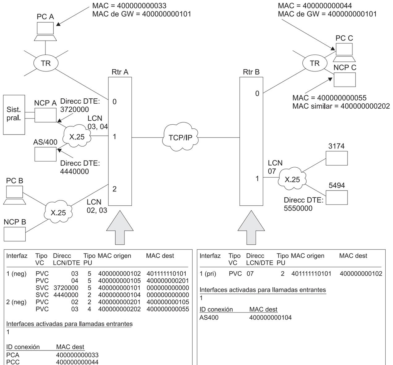
Figura 46. Ejemplo de configuraciones QLLC de DLSw
