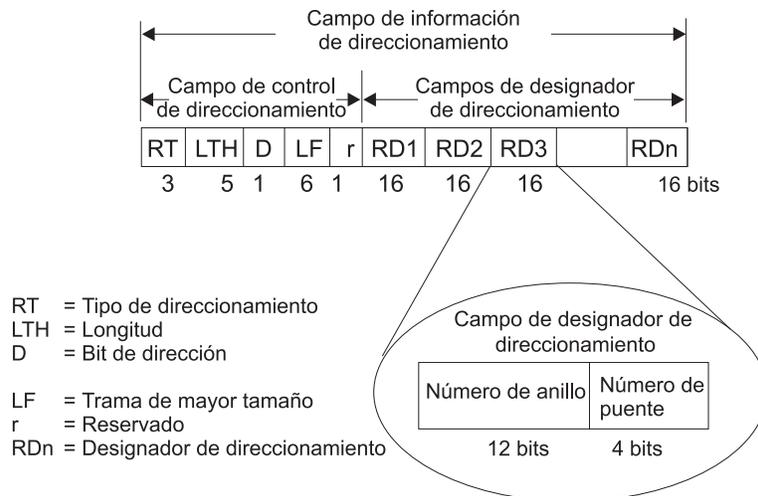
Figura 11. Campo de información de direccionamiento 802.5
