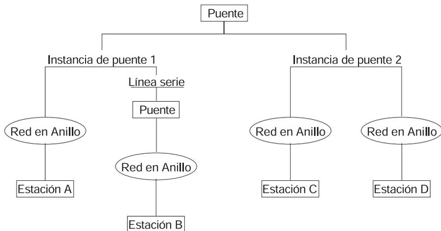
Figura 14. Instancias de puente dentro de un puente
