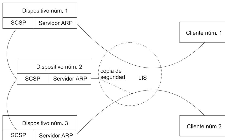
Figura 51. Configuración distribuida con tres Servidores ARP
