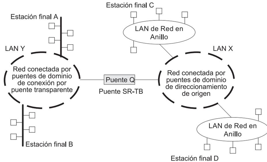
Figura 17. Ejemplos de conexión por puente SR-TB
