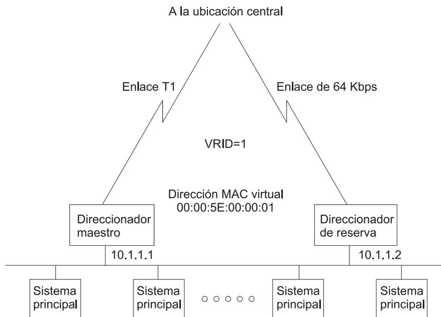
Figura 32. LAN Ethernet con subred 10.1.1.0/255.255.0. Todos los sistemas principales configurados con pasarela por omisión 10.1.1.1
