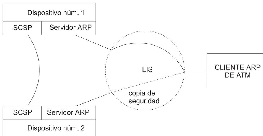
Figura 50. Configuración simple de Servidor ARP distribuido
