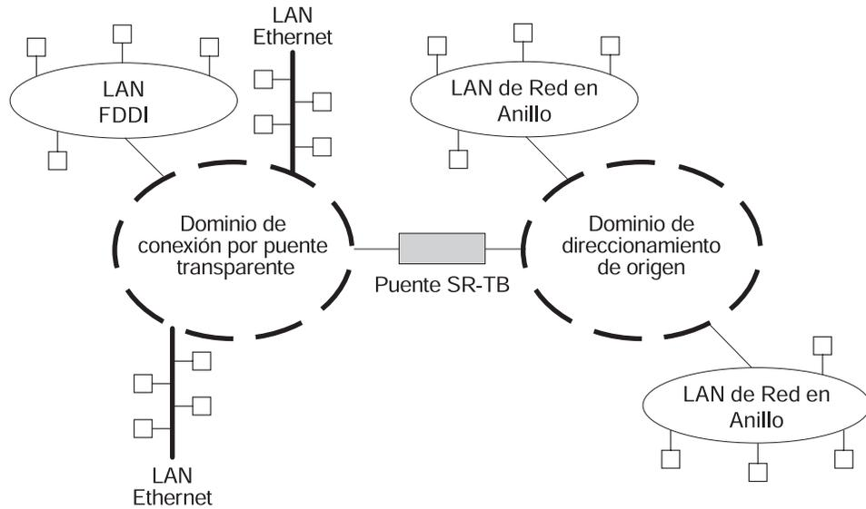
Figura 16. Puente SR-TB de conexión de dos dominios
